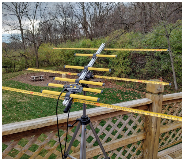
Antena fabricação confeccionada com trena
